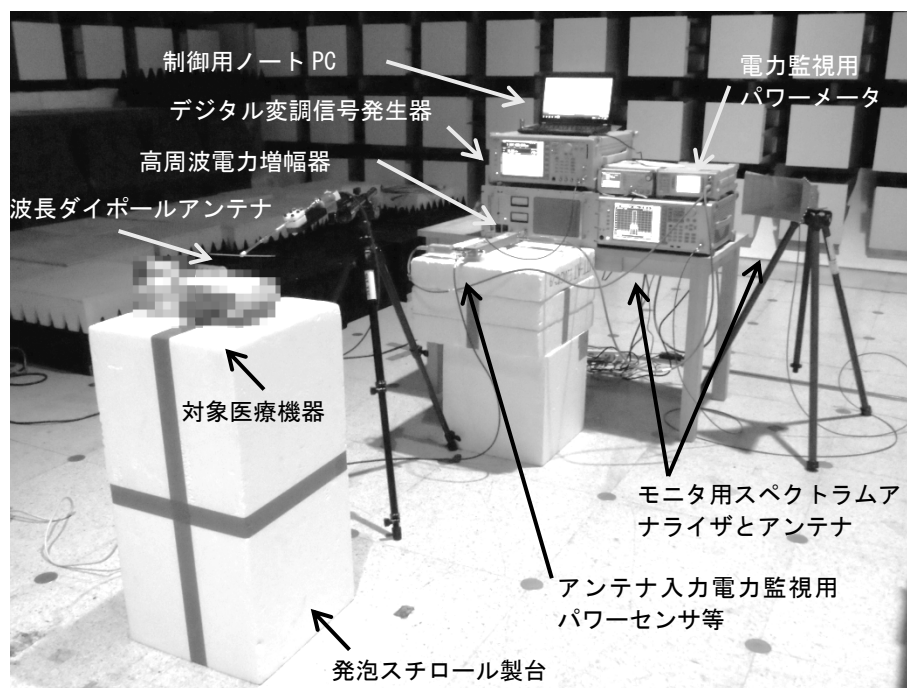
模擬システムの半波長ダイポールアンテナが電波発射源
