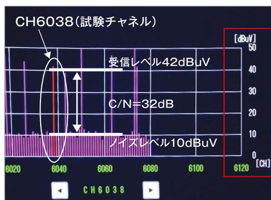
[注] 電波の強度を簡易的に測定・表示しており、数値は校正されていないため目安として扱うことが必要
