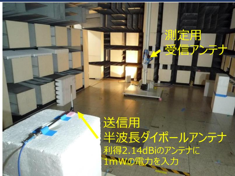
電波送信強度測定での送信機の設置状況 (例)
