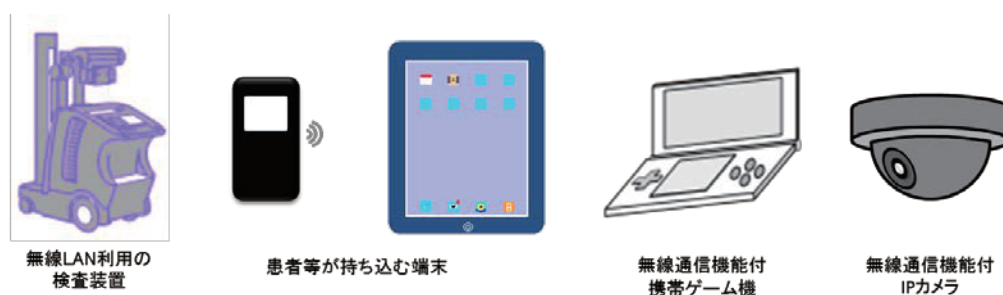
図 25 持ち込み端末や管理外の AP 等による電波干渉
