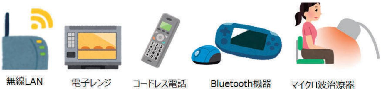
図 28 2.4GHz 帯を使う機器
