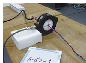
図5-14 測定状況及び電流プローブ通線イメージ
