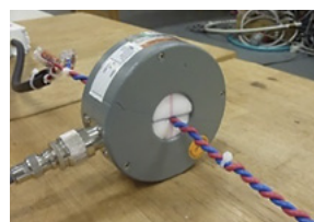
図5-11 測定状況及び電流プローブ通線イメージ
