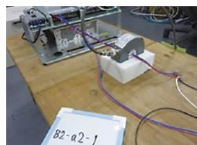
図5-17 測定状況及び電流プローブ通線イメージ
