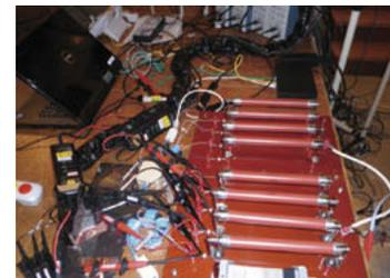
図2.5 各プローブの接続の様子 (CDN1の場合)
