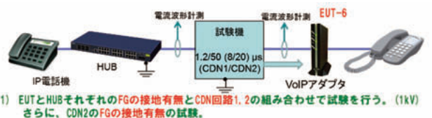
図3-5 EUT-5: IP電話機の試験構成および条件
