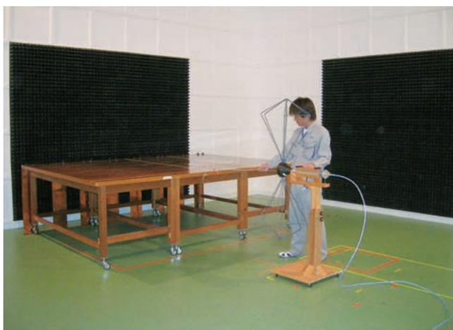
図8 車載機器用の電波暗室
