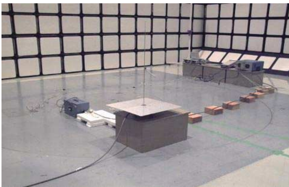
図2-4 V dm を変化させた場合のEUT設置位置における放射妨害波の電界強度測定
