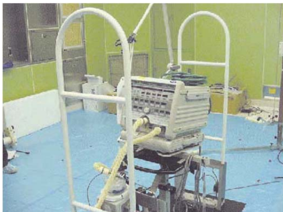
図 54 RFID 等からの電波の影響測定の状況例 33
