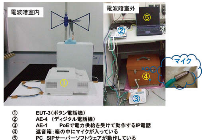
図16 EUT-3測定時の写真 (放射)
