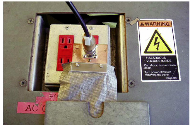
図11 コモンモードインピーダンス測定
